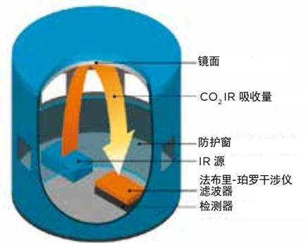
图 2. 维萨拉 CARBOCAP<sup>®</sup> CO<sub>2</sub> 传感器的结构
