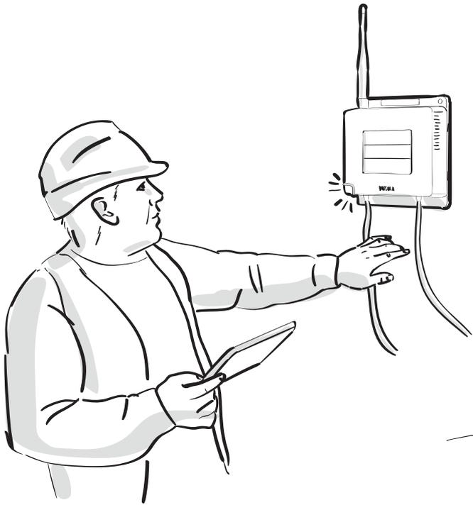
L'installation du point d'accès nécessite une alimentation secteur et Ethernet ou un modem cellulaire
