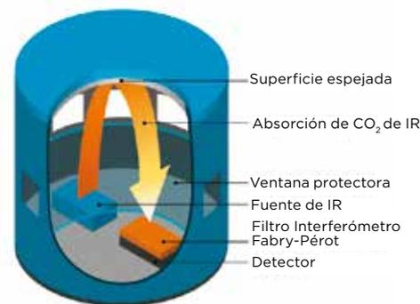
Figura 2. Estructura del sensor de CO<sub>2</sub> CARBOCAP® de Vaisala.
