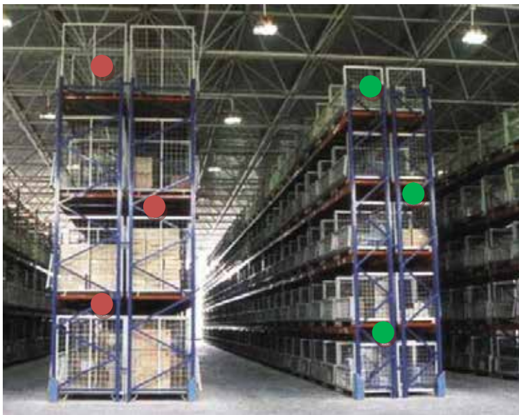
Kuva 2: Keskelle hyllyköitä asetetut anturit kuvaavat tarkemmin tuotteiden lämpötiloja. Tässä esimerkissä on yhdeksän anturia kutakin kaksoishyllykköä kohden varastossa, jonka mitat ovat 30 x 30 x 15 metriä.
