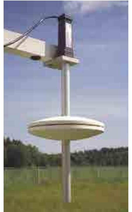
SPH10/20容易安装和连接。图中为SPH10静压头与PTB210气压表的连接。
