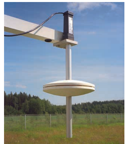
SPH10 スタティック・プレッシャー・ヘッドと組み合わせたPTB210
